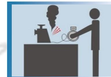
При возникновении дыма, искрения, дополнительного шума - немедленно отключите электроприемник
