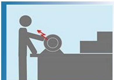
Появление напряжения на металлических нетоковедущих частях установок, корпусах, кожухах
